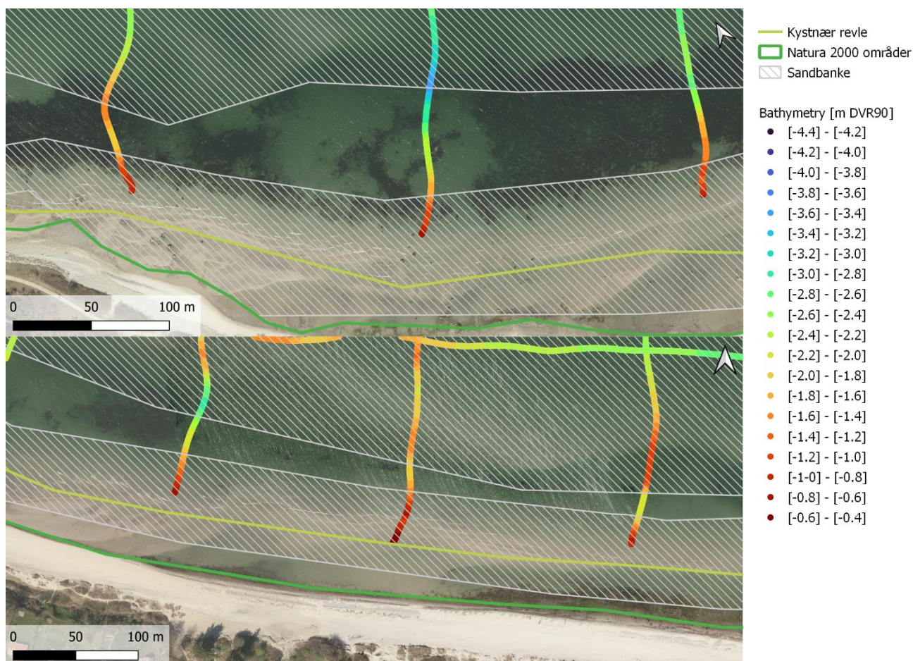
Figur 5.17: Eksempel hvor første revle tydeligt ses af ortofoto. Bølgerne bryder på revlen omkring 50 m fra vandlinjen.
